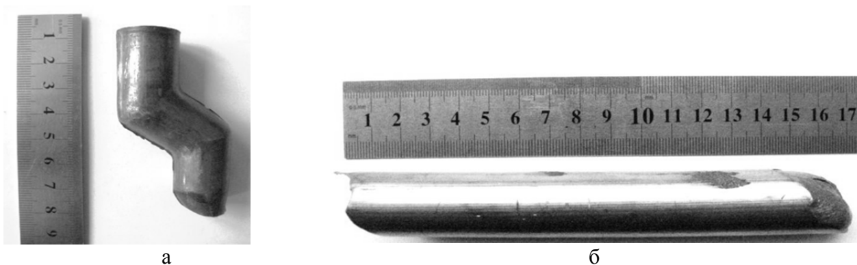
Рис. 2. Частично выдавленная заготовка (а) и прессованный пруток (б)
